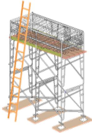
1. Sebelum menggunakan perancah anda harus memastikan *handrail*, *toe board* mesti minimum 16 mm dan *working platform* sudah tersedia.
