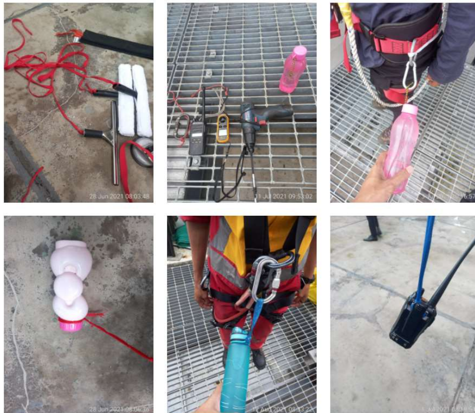
Photo 21. Berilah Ikatan Yang Sangat Kuat & Tidak Terlepaskan Pada Perangkat Kerja Seperti Bor Tangan, Botol, Radio HT, Tongkat, Wiper dan Lainnya Saat Bekerja Di Gondola. Give So Strong Connection Tied to Work Tools Such As Hand Drill, Bottle, Handy Talky, Stick, Wiper, etc When Working at Gondola.
