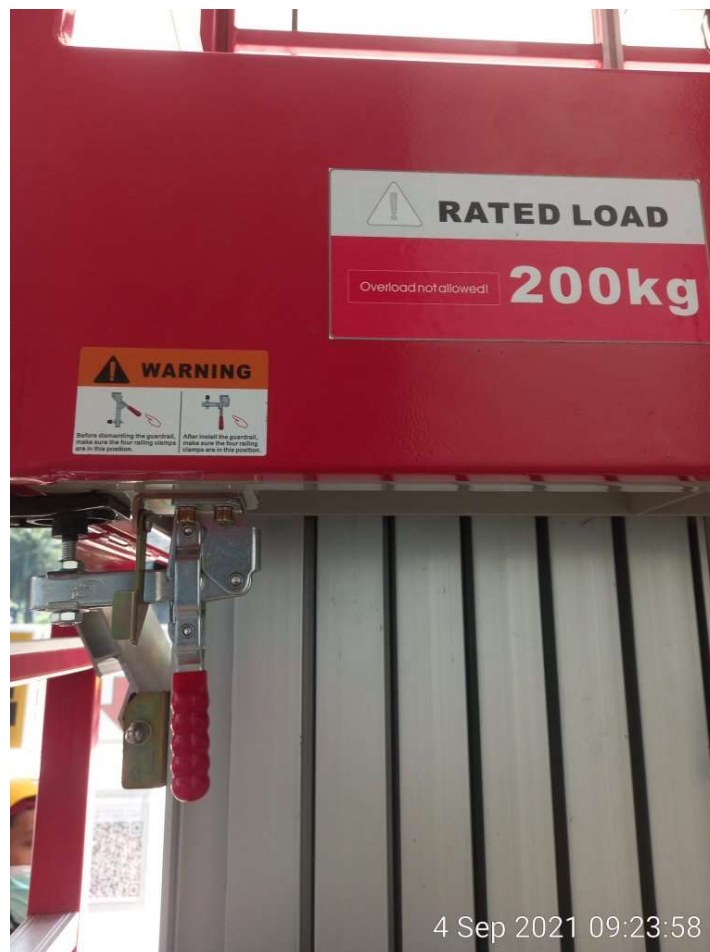
Photo 14. Periksa SWL atau Batas Aman Kemampuan Beban Angkut Manlift Dengan Mempertimbangkan Faktor Keselamatan atau Safety Factor 20%. Check The Manlift’s SWL or Safe Work Capacity to Consider Safety Factor 20%.
