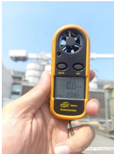
Photo 19. Tangan Seorang Petugas Keselamatan Mengecek Kecepatan Angin Dengan Anemometer 0 ke 9 Knot Adalah Keadaan Lingkungan Kerja Selamat. A Hand Personal Safety to Check Wind Velocity With Anemometer 0 to 9 Knot is Safe Work Environment Condition.
