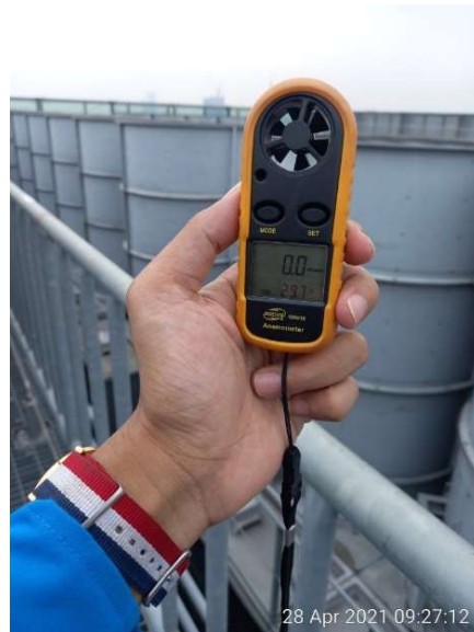
Photo 20. Tangan Seorang Petugas Keselamatan Mengecek Kecepatan Angin Dengan Anemometer 0 ke 9 Knot Adalah Keadaan Lingkungan Kerja Selamat. A Hand Personal Safety to Check Wind Velocity With Anemometer 0 to 9 Knot is Safe Work Environment Condition.
